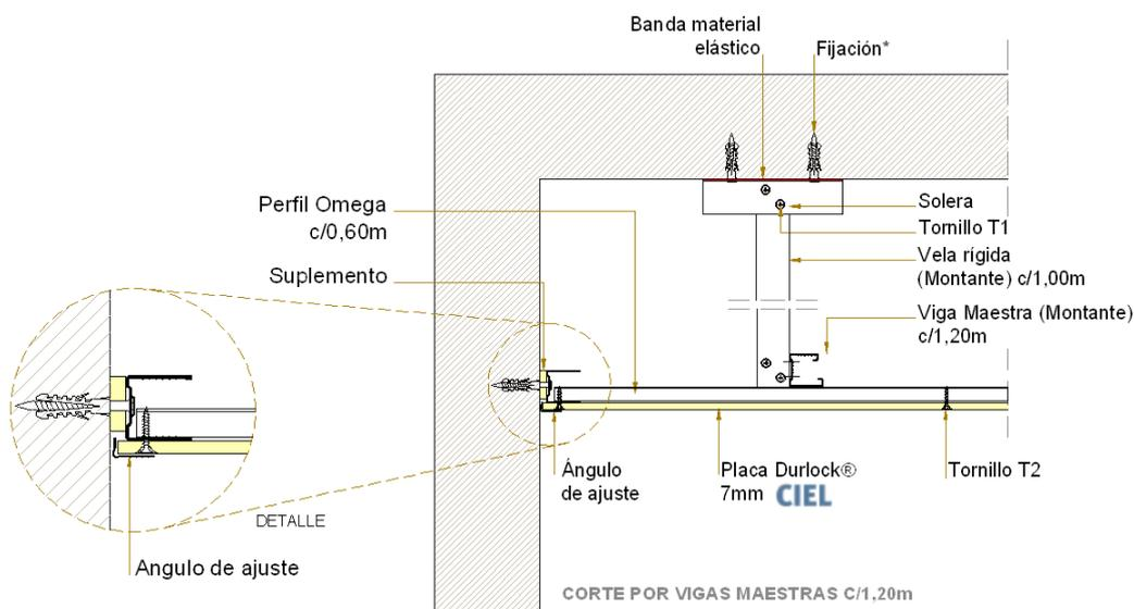
\* El perfil Ángulo de Ajuste o Buña Z de ajuste podrá fijarse con tornillos T2 colocados con una separación de 15cm o con adhesivo de contacto. Luego recibirá dos manos de masilla Durlock®.
