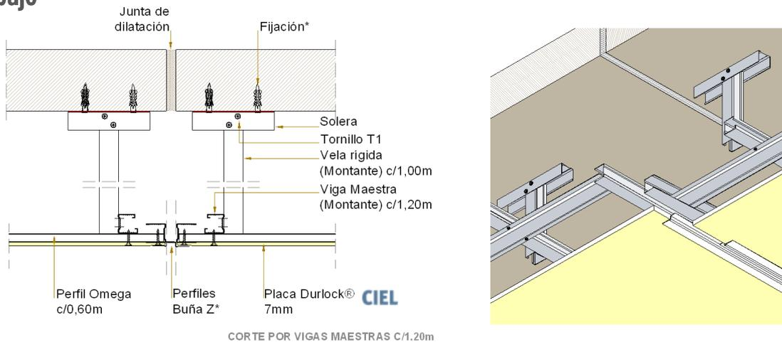
En grandes superficies se deben generar juntas de trabajo que definan módulos independientes, Tanto la continuidad de la superficie del cielorraso como su estructura deberán ser interrumpidas mediante estas juntas ubicadas con una distancia máxima de 10m en cualquier dirección, o en coincidencia con las juntas de dilatación del edificio. La terminación de la junta se realiza con dos perfiles de terminación Buña Z o ángulo de Ajuste.
