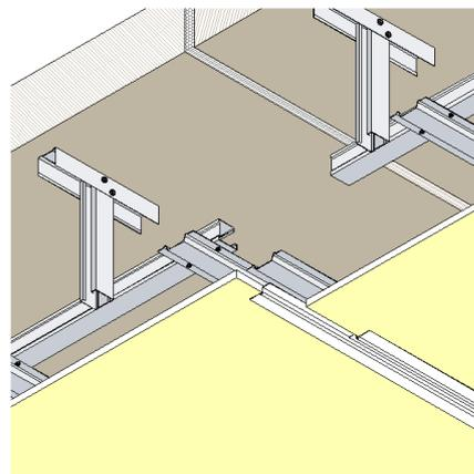
En grandes superficies se deben generar juntas de trabajo que definan módulos independientes, Tanto la continuidad de la superficie del cielorraso como su estructura deberán ser interrumpidas mediante estas juntas ubicadas con una distancia máxima de 10m en cualquier dirección, o en coincidencia con las juntas de dilatación del edificio. La terminación de la junta se realiza con dos perfiles de terminación Buña Z o Ángulo de Ajuste.
